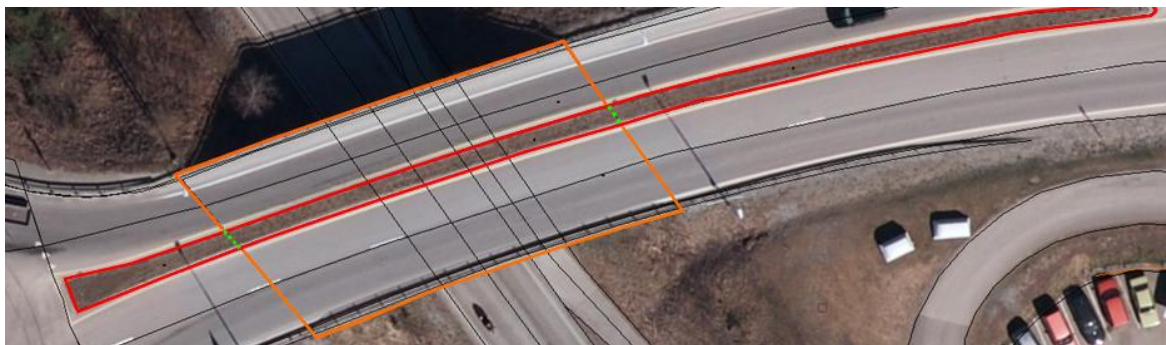
Figur 7. Eksempel på registrering av trafikkøyr som delvis ligger på bru. Her er det benyttet VegFiktivGrense (grønn stiple) for å avgrense delen av trafikkøya som ligger oppe på brua (MEDIUM L) (Kilde: FKB Registreringsinstruks).
